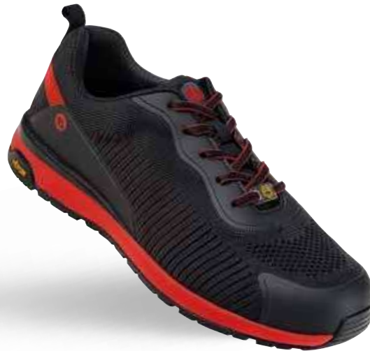
BATA Spark Halbschuh S1P Material: Textil / TPU Futter: Atmungsaktives Textil Sicherheit: Kunststoffkappe, metallfreier Durchtrittschutz Sohle: EVA/Nitril Größen: 39 - 47 Besonderheiten: Vibram®-Laufsohle, nahtlose Schaftgestaltung durch flexibles, widerstandsfähiges Gewebe, TPU-Vorderkappenschutz, lederfrei
