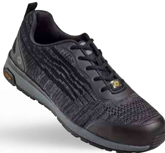
BATA Fit Halbschuh S1P Material: Textil / TPU Futter: Atmungsaktives Textil Sicherheit: Kunststoffkappe, metallfreier Durchtrittschutz Sohle: EVA/Nitril Größen: 39 - 47 Besonderheiten: Vibram®-Laufsohle, nahtlose Schaftgestaltung durch flexibles, widerstandsfähiges Gewebe, TPU-Vorderkappenschutz, lederfrei
